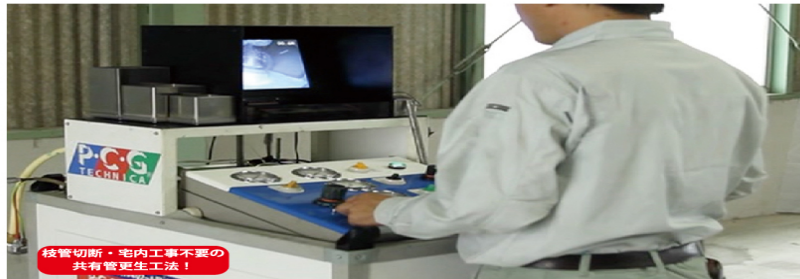
管内カメラで確認して分岐部枝削孔とライニング加工
